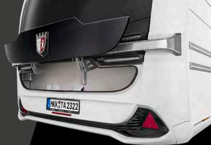
Les raccordements d'électricité et d'eau de ville intégrés dans le spacieux coffre arrière contribuent à éviter les ponts thermiques causés par les ouvertures dans les parois latérales.
