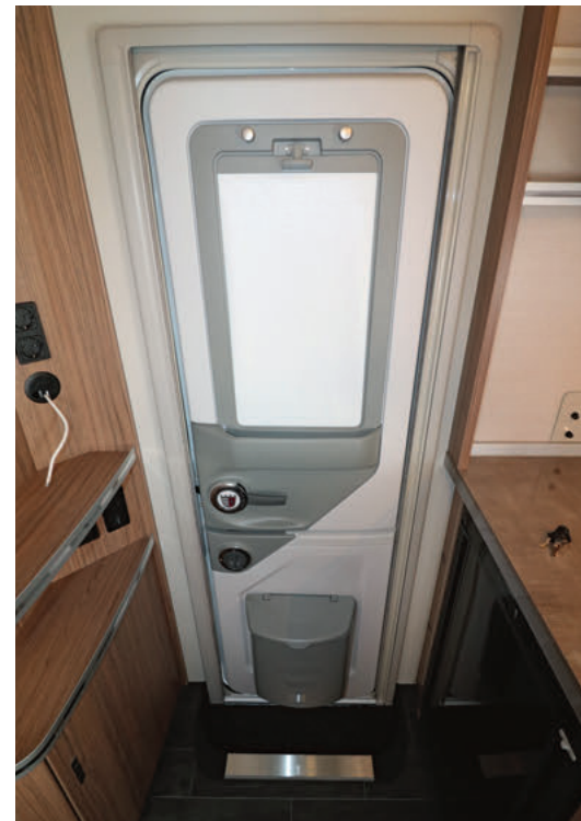
Fenster mit Rollo, Kleiderhaken und Müllbehälter an der geteilten Eingangstür.
