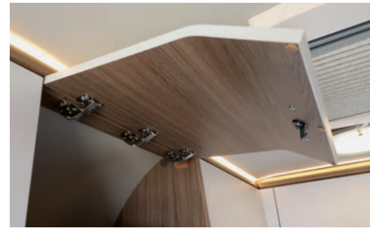
Solide Metallscharniere und sichere Hakenschnäpfer finden sich an allen Hängeschränk-Klappen.
